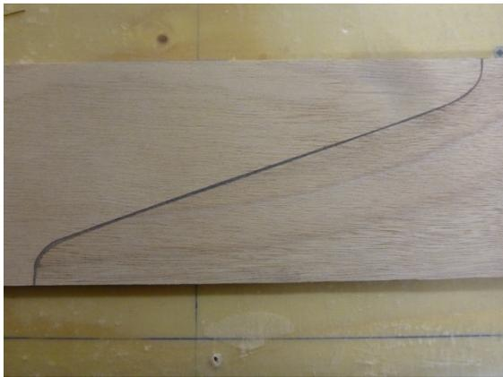
Diese Verbindung ist auf der Außenseite sauber abgeschliffen. Sie ist gleichmässig breit – wirklich schön geworden.
