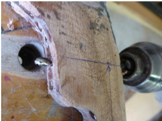
Das Bohren von 4 mm-Löchern durch den Skeg hindurch ist wirklich leicht, denn der Bohrer wird von dem Glasgewebe zwischen den Skegdopplungen geführt. Jedenfalls so lange wie er nicht überhitzt – dann würde das Epoxy weich. Damit das nicht passiert: Mit langsamer Umdrehungszahl bohren, eher kräftiger drücken. Beides hält Bohrer und Bohrstelle kalt.
