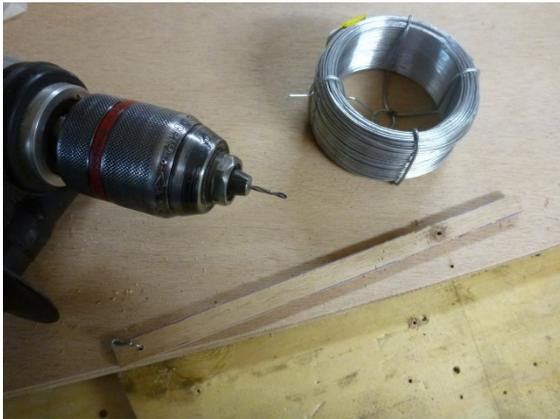
Die rechten und linken Planken kann man mit einer Zwinde zusammenspannen und direkt zusammen bohren –das spart Zeit.
