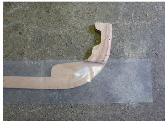
Dann den Skeg umdrehen und die Unterkante bis zu den Skegdopplungen epoxieren:
