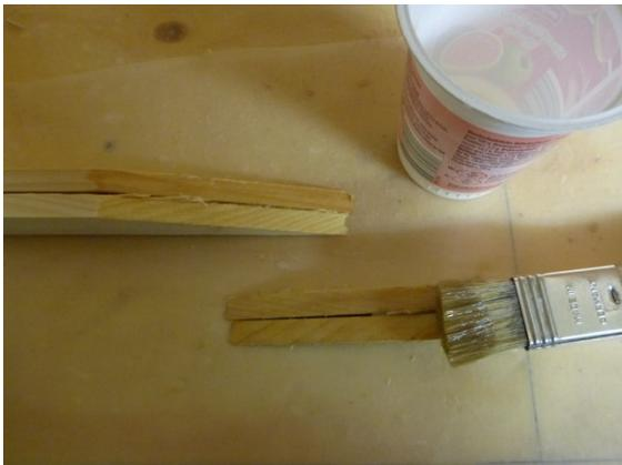
Wenn das Epoxy gerade etwas dickflüssig wird, mischt man ein wenig Spachtelpulver darunter. Das angedickte Epoxy soll gerade noch fließen:
