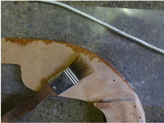
Warten, bis das Epoxy gerade anfängt, dickflüssig zu werden. Die etwas länger als nötig zugeschnittene Glasfaserschnur in Epoxy einlegen, damit sie sich vollsaugt. Ich habe ich dem Epoxy noch etwas Graphit zugefügt – dadurch wird die Oberfläche extrem hart und rutschig. Glasfaserschnur auflegen...
