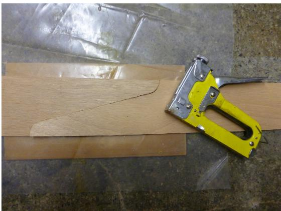
Die Klebestelle wird mit Folie unterlegt, damit die Planke nicht am Untergrund anklebt.
