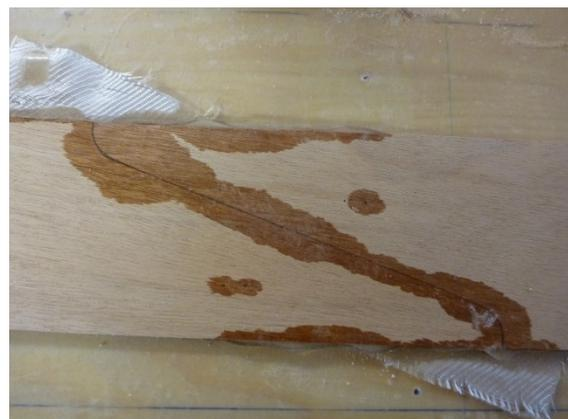
Diese Verklebung sieht auf der Außenseite wirklich sauber aus. Etwas Epoxy ist durch die Fuge gesickert und hat sie durchgängig verklebt. Gut so!
