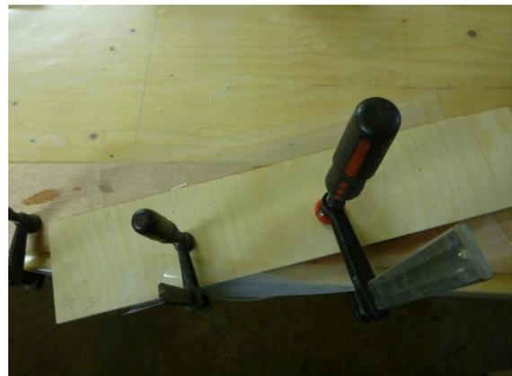
**Epoxy klebt raumfüllend.** Wenn man Epoxy mit Zwingen verklebt, darf man sie **nur leicht anziehen**. Die Zwingen sollen nur das Glasgewebe an das Holz drücken. Wenn man sie fest anziehen würde, dann würde man das Epoxy aus der Fuge pressen. Zwischen den Teilen würde kein Epoxy mehr übrig bleiben, und die Verbindung würde nicht gut halten.
