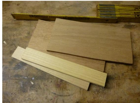
Diese Teile vernagel ich so miteinander, dass eine Leiste sauber und ohne Spiel durch den Spalt in der Mitte läuft. Zwischen den Leisten und der Platte nagle ich etwas Baufolie ein – die sorgt für den richtigen Abstand, und die Leiste in der Mitte läuft leichter.
