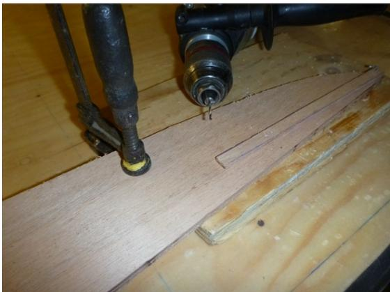
Bohre die kleinen Löcher mit einem scharfen Bohrer, hoher Geschwindigkeit und wenig Druck, lege ein Abfallholz unter, wenn möglich. Auf diese Weise franst das Bohrloch nicht aus.
