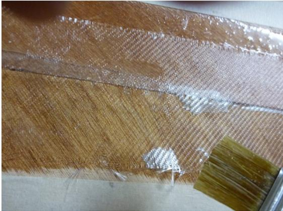
Im Bild über diesem Text sind zwei Stellen erkennbar, an denen das Glasgewebe weiß geblieben ist. Hier mit dem Pinsel etwas Epoxy nachtöpfeln, bis die Stellen ebenfalls transparent sind. Im Bild unter diesem Text sind alle Stellen mit Epoxy gesättigt.
