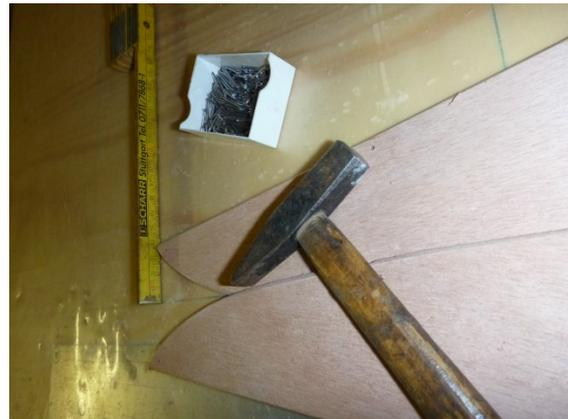
Auf dem Bild habe ich die Spitzen an der Mittellinie eines langen Tisches ausgerichtet und mit kleinen Drahtstiften auf dem Tisch befestigt. Ja, die beiden vorderen Plankensegmente überlappen sich etwas an der Mittellinie – das ist richtig so!
