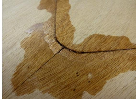
Hier lagen die Platten beim Kleben nicht sauber nebeneinander. Jetzt ist auf der Außenseite der Planken eine Stufe entstanden. Da es die Bodenplanke ist, kann man das überstehende Plankensegment später etwas anhebeln und den Rest ausspachteln.
