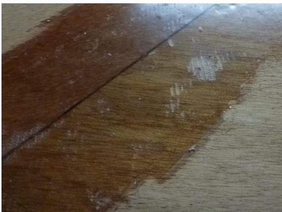
Hier ist zu wenig Epoxy aufgetragen worden. Außerdem habe ich die Luftblasen unter dem Glasgewebe nicht vollständig zur Seite weggedrückt. Dadurch sind weiße Stellen entstanden. Die Klebung ist insgesamt noch ausreichend. Aber die weißen Stellen werden auffallen, wenn man später das Bootsinnere mit Glasfasergewebe und Epoxy beschichtet. Deshalb werde ich die
