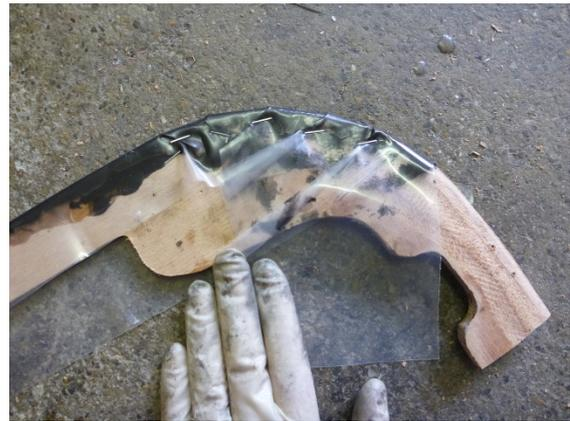
Wie das Bild zeigt, muss die Glasfaserschnur am hinteren Ende nur über die Kurve, bis zu den Skegdopplungen, nicht bis ganz nach oben gehen.
