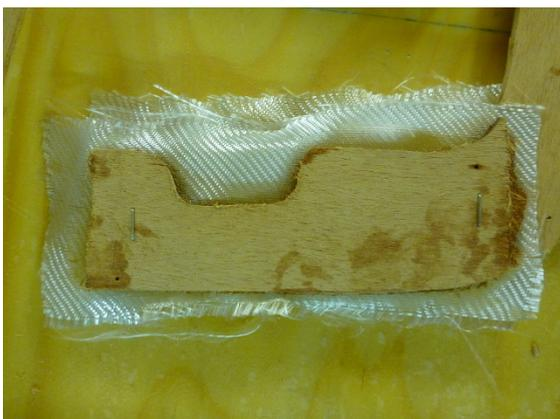
Nach dem Trocknen wird die Vorderseite des Skegs mit der Raspel grob versäubert. Die hintere Seite wird mit Hobel und Raspel auf beiden Seiten angeschrägt, um eine gute Klebestelle für die Planken zu schaffen:
