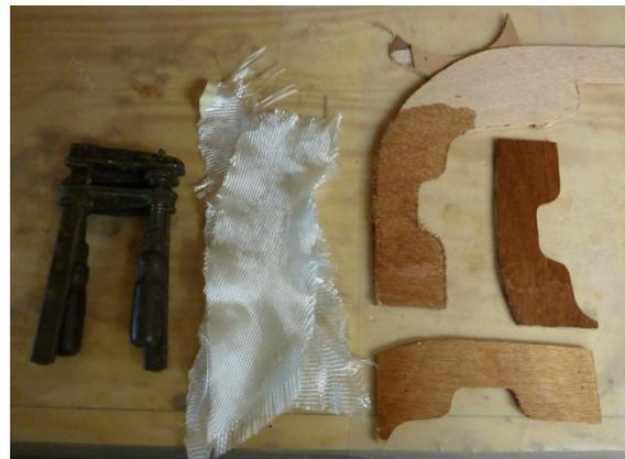
Wenn das Epoxy gerade anfängt, dickflüssig zu werden, legt man Glasgewebestreifen auf und pinselt etwas Epoxy nach, bis sie transparent werden. Diese beiden könnten noch etwas Epoxy vertragen:
