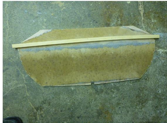
Soll das Boot schmaler werden, dann müssen die Bauspanten B, C und D an den Kontaktflächen zu Planke 2, 3 und 4 etwas schmaler geschnitten werden.
