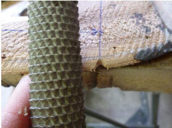
Wenn man die Aussenkante etwas ankerbt, fasst der Bohrer leichter.
